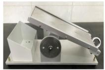
Fig. 6 - CNY-1 inclinometer
