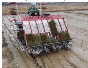
(d) Completion of automatic seedling loading
