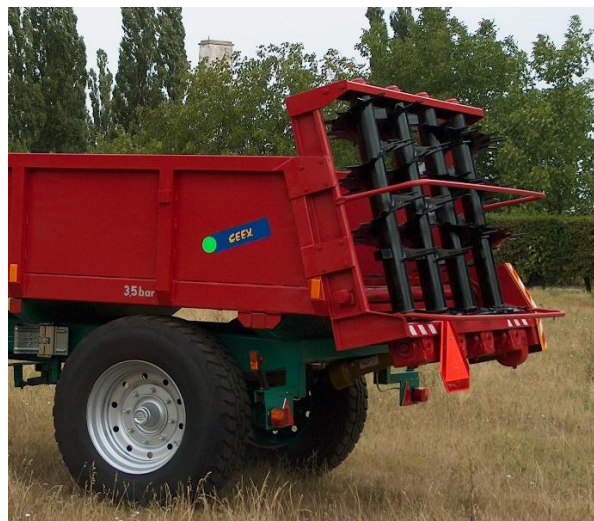
b) 4 vertical rotors MG 5 Experimental model (Popa L., 2009; Ștefan, 2023)
