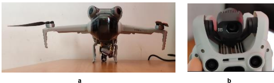
Fig. 4 – DJI Mini 4 Pro with payload (a) and gimbal (b)
